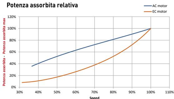
Il risparmio di consumo elettrico con un motore EC regolato al 40% della velocità massima è circa del 70% rispetto ad un motore AC tradizionale.
