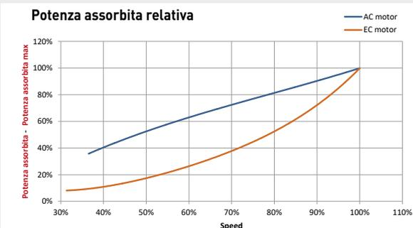
Il risparmio di consumo elettrico con un motore EC regolato al 40% della velocità massima è circa del 70% rispetto ad un motore AC tradizionale.
